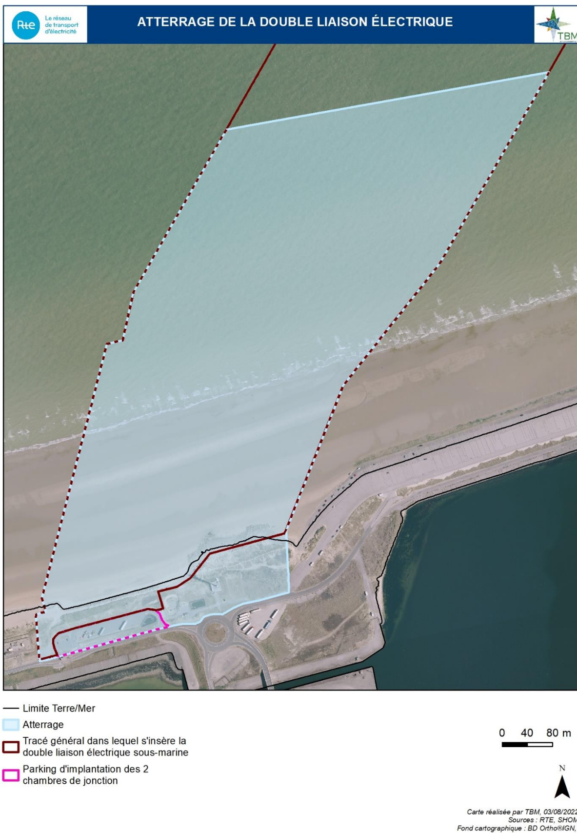
Figure 6 : Zone d'atterrage et parking où seront installées les deux chambres de jonction
